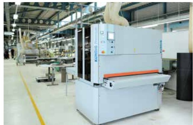
Die zweite Maschine, eine Zweiband-Kündig Premium, wird für schwere Kalibrierschleifarbeiten eingesetzt.
