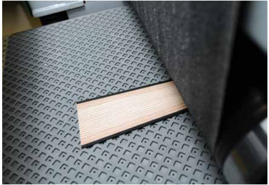
Durch eine Vakuumaufspannung werden die Teile sicher bei Zerspanungsleistungen von bis zu 16mm geführt.
