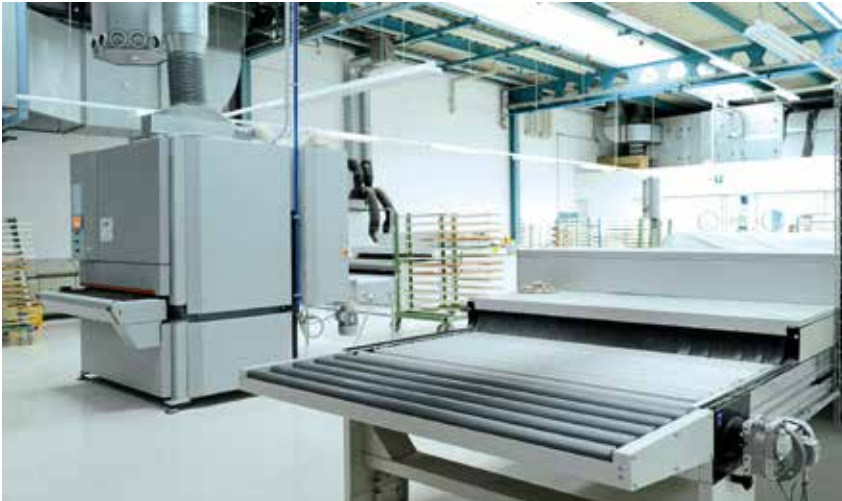
Die geringe Staubentwicklung ermöglicht den Betrieb direkt neben der UV-Lackieranlage.
