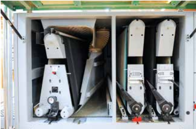
Mit zwei Längsschliff- und einem Diagonalaggregat (v. re.) kann in einem Durchlauf eine fertige Oberfläche hergestellt werden.
