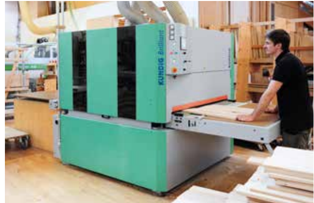
Die Massivholzplatten können in einem Durchlauf vom Putzen bis zur fertigen Oberfläche bearbeitet werden.
