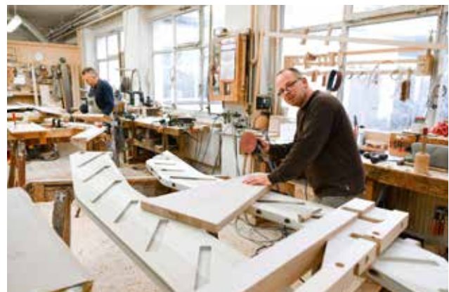
Treppenbau Stöver in Tostedt hat sich mit eingestemten Wangentritten einen guten Ruf erworben.
