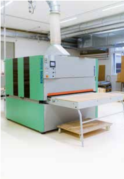
Trotz üppiger 1600 mm Arbeitsbreite ist die Anlage insgesamt kompakt.
