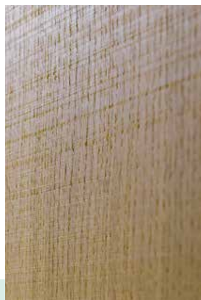
„Sägerau“ (li.) und „gebürstet“ (re.), hergestellt mit einer ganz normalen Breitband-Schleifmaschine von Kündig.
