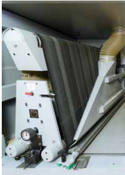
Die V-förmig stehenden Aggregate erlauben es, Rahmen gerade einzulassen und die Maschinenbreite mit dem Element auszunutzen. Obendrein werden die Oberflächen glatter.
