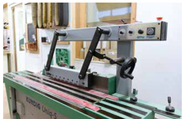
Lackoption: Stufenlos regelbare Vorschub- und Bandgeschwindigkeit und ein getasteter Schleifschuh mit einstellbarer Einsatzzeit.
