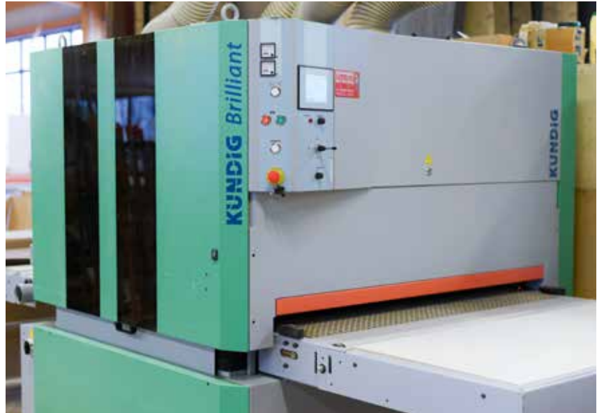
Diese Kündig Brilliant-3 1350-REdBs-L verfügt neben Kalibrier- und Diagonalaggregat auch über ein Bürstaggregat – damit sei sie universell verwendbar, ist man bei Dohm zufrieden.
