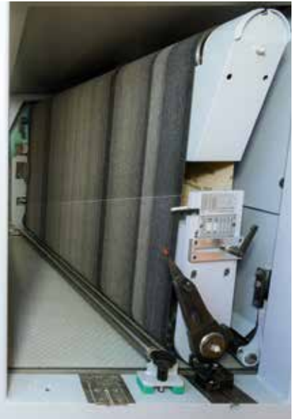
Die V-förmig stehenden Aggregate erlauben es, Rahmen gerade einzulassen und die Maschinenbreite mit dem Element auszunutzen. Obendrein werden die Oberflächen glatter.
