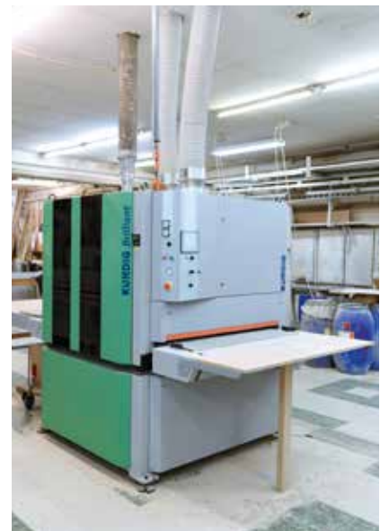
Die Hebelkräfte durch lange Teile steckt das bei Kündig stärker als üblich dimensionierte Maschinenchassis problemlos weg.
