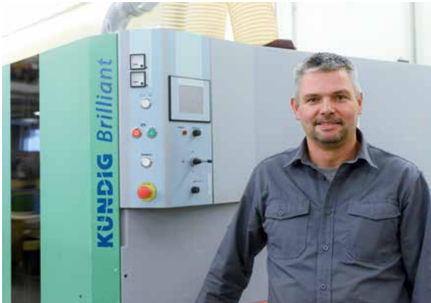
Ein zusätzliches Querband sei durch das Diagonalaggregat der Kündig Brilliant nicht nötig, sagt Schwörer. Vorschub- und Bandgeschwindigkeit sind zudem stufenlos regulierbar.
