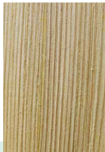
... sondern auch mit einem extrem groben „Kieselstein“-Schleifband zur Herstellung von Struktureffekten.
