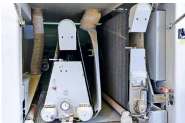
Die Maschine ist mit Diagonalaggregat mit pneumatischem Schleifschuh (li.) und einem Walzenaggregat ausgerüstet.
