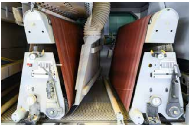
Die Maschine ist mit zwei Kombiaggregaten, eines davon in Diagonalausführung und einem Querband ausgerüstet.
