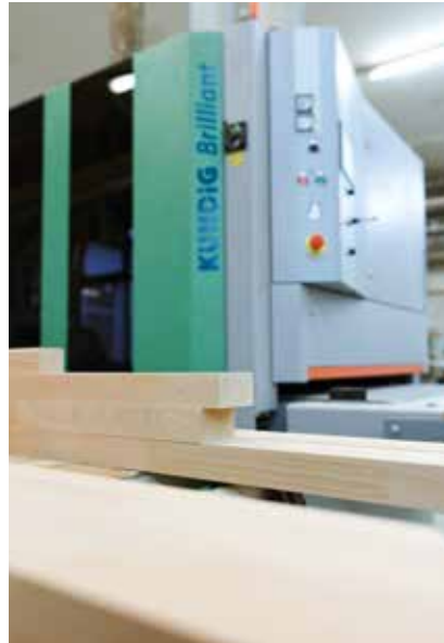
Die Kündig kann nicht nur lange, sondern auch kurze oder schmale Stücke schleifen.
