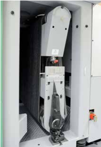
Das Schleifaggregat bewegt sich in der Z-Achse.
