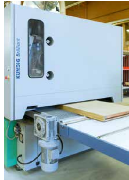
Das Querband wird nicht nur für Feinschleifarbeiten genutzt...
