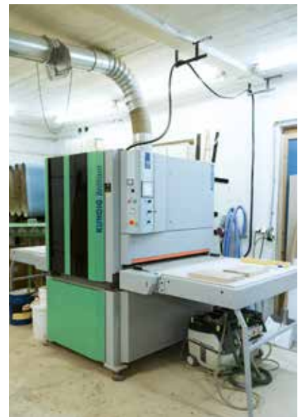
Die Kündig Brilliant 1100 Cd ist mit einem kombinierten Rollen-Schuhaggregat und Diagonalschleiftechnik ausgerüstet.
