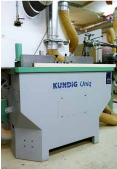
Bei der Uniq oszilliert das gesamte Schleifaggregat. Deshalb kann man das Schleifband gleichmäßiger ausnutzen.
