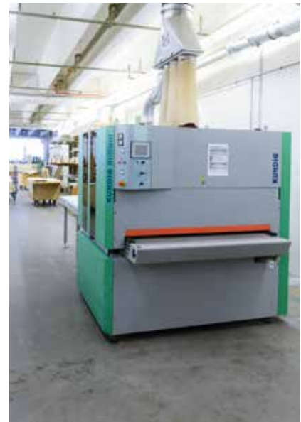
Die Kündig Brilliant-2 1350 RED-Lack verfügt über ein Rollen- und ein Diagonalaggregat.
