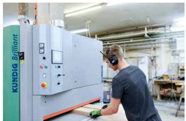
Durch das Diagonalaggregat kann auch schräg oder quer zur Faser eine sehr glatte Oberfläche erzielt werden.
