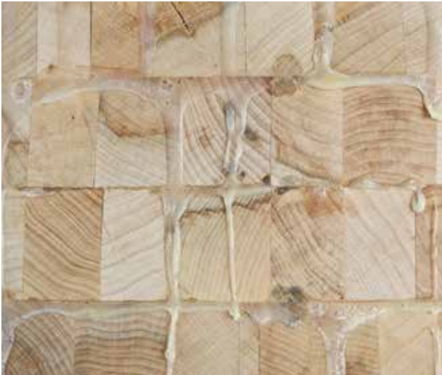
До и после: колода, состоящая из склеенных между собой брусков разной высоты, выравнивается при помощи двух строгальных агрегатов. Калибровочные валки и устройство диагонального шлифования призваны обеспечить безупречное качество поверхности
