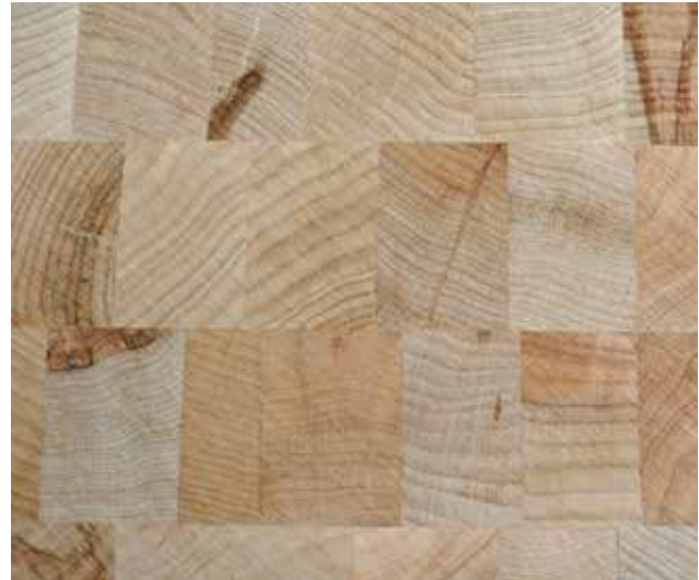
До и после: колода, состоящая из склеенных между собой брусков разной высоты, выравнивается при помощи двух строгальных агрегатов. Калибровочные валки и устройство диагонального шлифования призваны обеспечить безупречное качество поверхности
