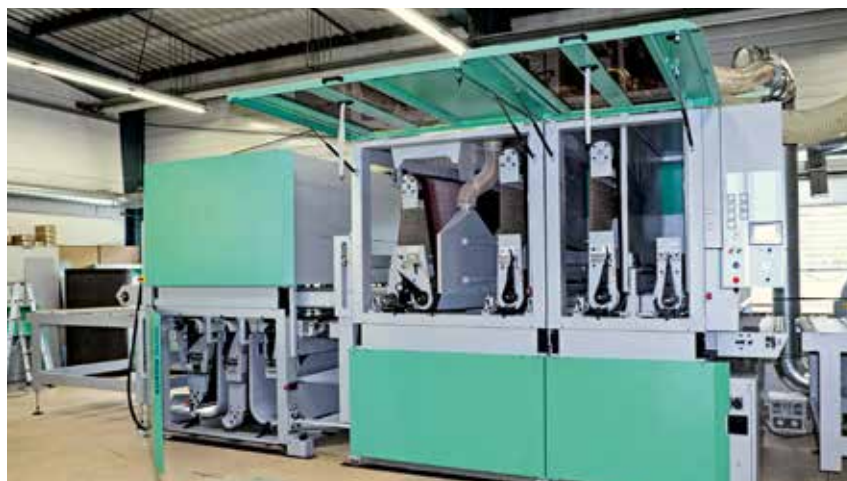
Станок Votor-7 марки Kündig оснащен строгальными агрегатами, калибровочными валами и поворотным электронным утюжком, что позволяет выполнять все технологические операции за один проход
