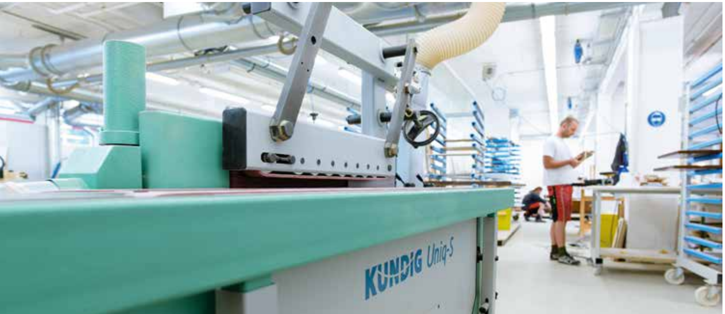
Три транспортные ленты станка Kündig Uniq-S Lack обеспечивают бережную обработку при подаче чувствительных поверхностей на высокий глянец. Режим подачи и скорость шлифовальной ленты предусматривают плавную регулировку для любой лакированной поверхности.
