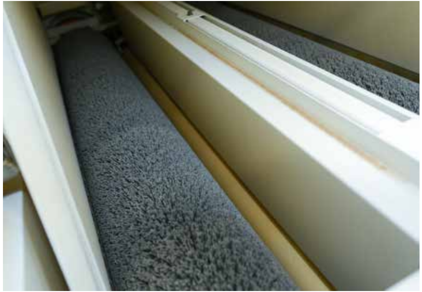
... а две нейлоновые щетки вращающиеся в противоположном направлении снимают поднявшийся ворс и сглаживают острые углы. В результате получается более гладкая и плотная поверхность.
