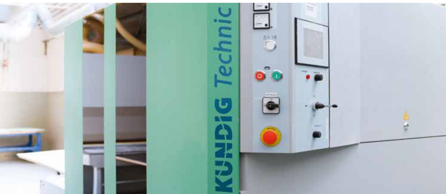
Станок Kündig Technic Precision-2 1350 R/Rtz позволил компании Von Roll Composites привлечь новых заказчиков на высококонкурентном рынке. Высокоточный шлифовальный станок обеспечивает шлифовку композитных плат с допуском менее \pm 0,03 мм.
