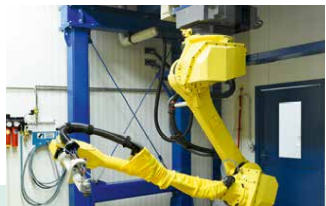
В инструментальном парке компании Remmers представлен даже промышленный шестиосевой покрасочный робот с системой распознавания элементов 3D.
