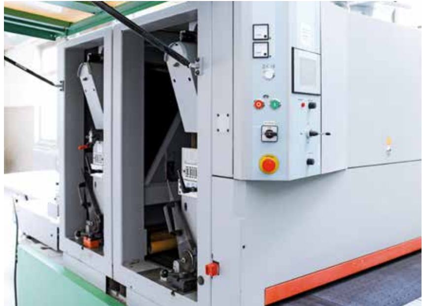
Два прецизионных шлифовальных агрегата позволяют обеспечить необходимый допуск по толщине материала по всей ширине рабочей ширине.
