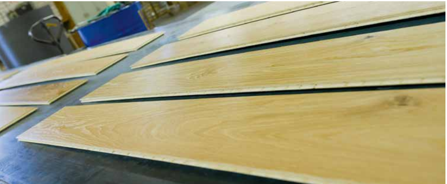
Такой безупречный паркет покрытый маслом производит компания Trumpf на щеточном станке Kündig Technic. Станок, изготовленный по индивидуальному заказу, обладает достаточной мощностью для одновременного браширования паркета в четыре ряда.
