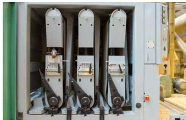
Die Bestückung mit drei Körnungen erlaubt es, in einem Durchgang von der gehobelten zur fertigen Oberfläche zu kommen.
