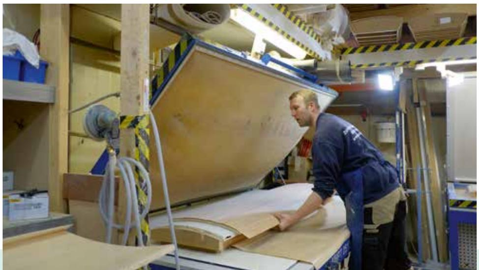
Brilliant-3 1100-RRPd werden die Kalibrier-, Furnier- und Massivholzschleifarbeiten gemacht – in großem Umfang, in Serienfertigung. Sie spart Bearbeitungszeit, weil mit den drei Schleifaggregaten fertige Oberflächen in einem Durchlauf entstehen.
