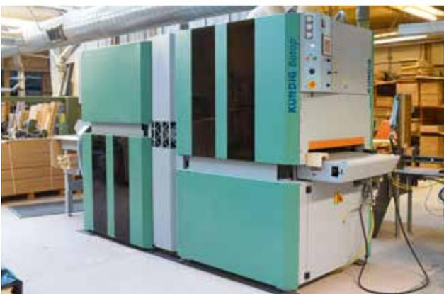
Insgesamt sechs Schleifaggregate ermöglichen bei der Kündig Technic Botop-6 650-RRR-RRR die beidseitige Bearbeitung.
